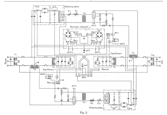
même temps, le relais  $\mathrm{Re}_3$  opère et, par ses contacts, effectue une liaison directe entre les deux lignes Ouest et Est de sorte que si le répéteur est hors service, le circuit peut encore être utilisé avec un équivalent plus grand. Un autre contact de ce relais court-circuitera l'entrée du répéteur de manière à empêcher le répéteur de siffler.
