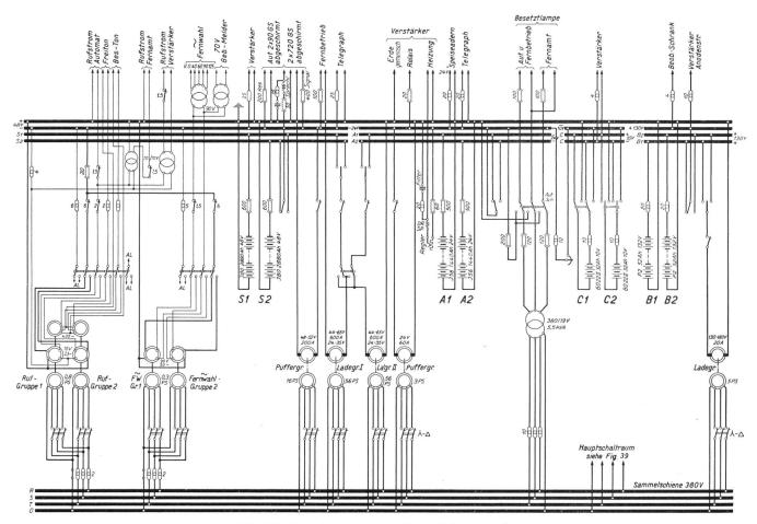
Abb. 36. Prinzipschema der Stromlieferungsanlage.
