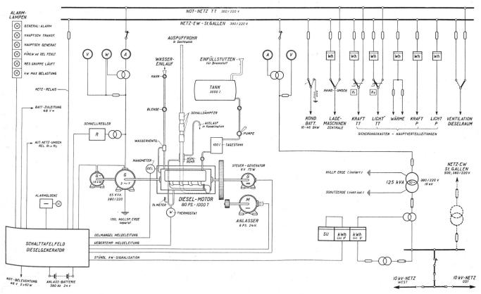
Abb. 39. Schema der Starkstromanlage mit dieselelektrischer Notreserve.
