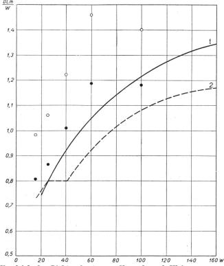
Vergleich der Lichtausbeute von Normal- und Kleinspannungslampen. Efficacité lumineuse comparée des lampes à tension normale et
