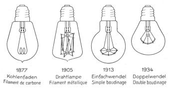
Fig. 1. Die hauptsächlichsten Drahtformen der Glühlampe. Evolution du filament des lampes à incandescence.
