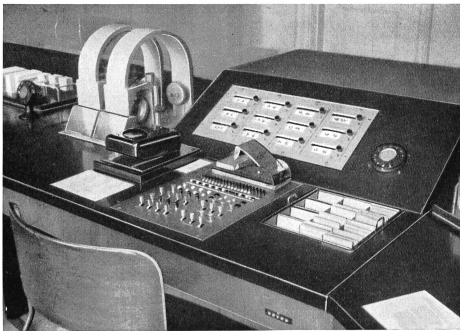
Abbildung 22. Fernanmeldeplatz mit Rohrpost.
