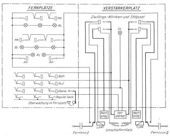
Abbildung 27. Verbindungsdiagramm. Transitverbindung mit Schnurverstärkung.
