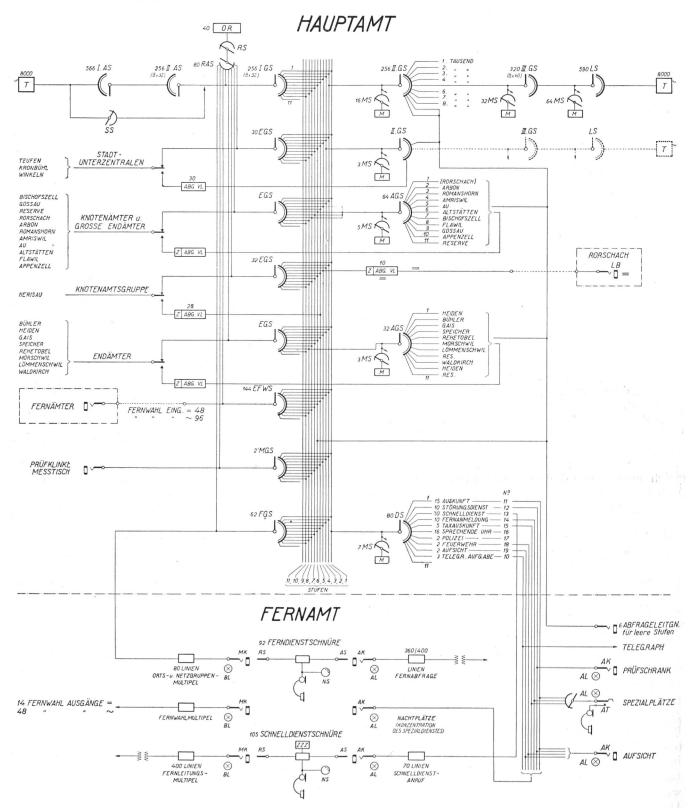
Abb. 6. Netzgruppen-Hauptamt und Fernendamt St. Gallen. Verbindungsdiagramm.
