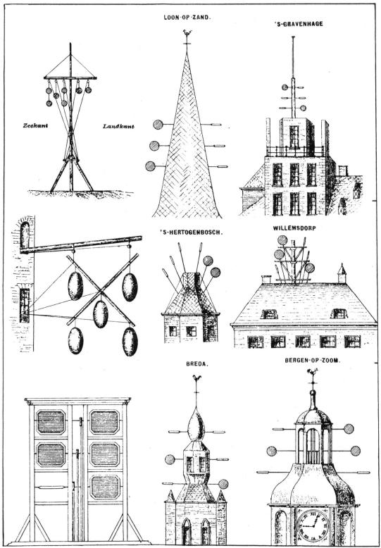
Fig. 17. Holländische Telegraphen. — Télégraphes hollandais.
