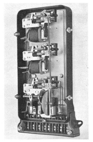
Fig. 3. Phasenschutzrelais Landis & Gyr, Zug. Ansicht des Apparates. Relais protecteur de phases Landis & Gyr, Zug.
