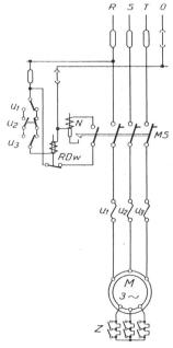
Fig. 1. Prinzipschema. — R-S-T-O = Netz, MS = Motorschutzschalter, N = Nullspannungsmagnet, M = Asynchronmotor, Z = Zentrifugalanlasser,  $\mathbf{u}_1$ ,  $\mathbf{u}_2$ ,  $\mathbf{u}_3$  = Stromrelais, RDw = Auslöserelais.
