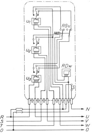
Fig. 2. Phasenschutzrelais Landis & Gyr, Zug. Schema. — R-S-T-O = Netzanschluss, U-V-W-O = Motoranschluss, N = Nullspannungsauslösung,  $\mathbf{u}_1,\ \mathbf{u}_2,\ \mathbf{u}_3$  = Stromrelais, RDw und S = Auslöserelais, RGu = Hilfsrelais.
