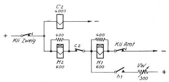
Fig. 8. Ein Anruf vom Amt ist abgefragt und der zweite Stöpsel wird in die Zweigklinke gesteckt.
