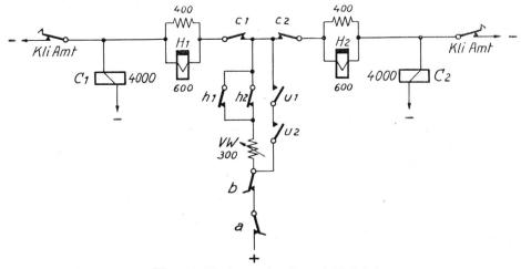
Fig. 7b. Schaltung der C- und H-Relais.
