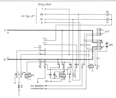
Fig. 11. Amtsklinke mit M-Relais für Zwischen-Verbindungsverkehr.
