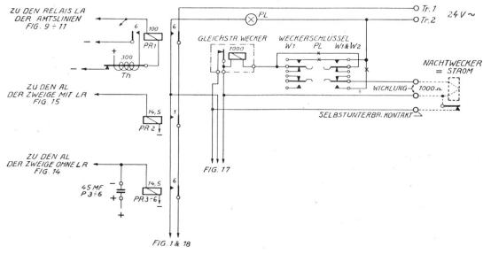
Fig. 16. Pilot- und Weckerstromkreise.
