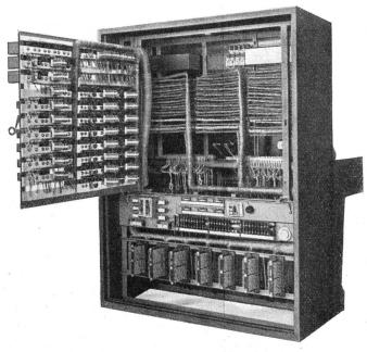
Fig. 21. Universalschnurschrank mit geöffnetem Relaisrahmen.
