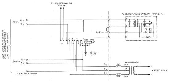
Fig. 17. Wechselstromversorgung.
