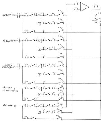
Fig. 10. Amplificateurs radiophoniques de Zurich. Programme]
