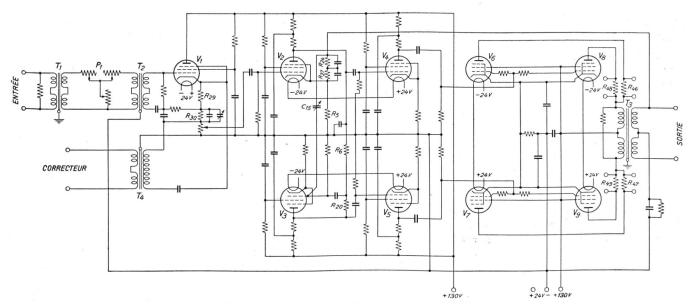
Fig. 5. Amplificateur radiophonique type 1938.
