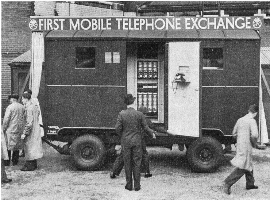
Abb. 1. Die automatische Zentrale.
