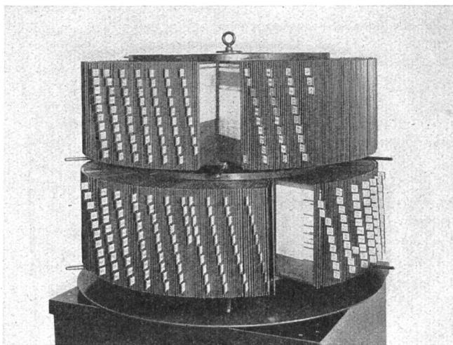
Fig. 3. Sichtstreifenanlage zu zwei Trommeln für 120 000 Adressen. System Furrer Söhne, Zürich.
