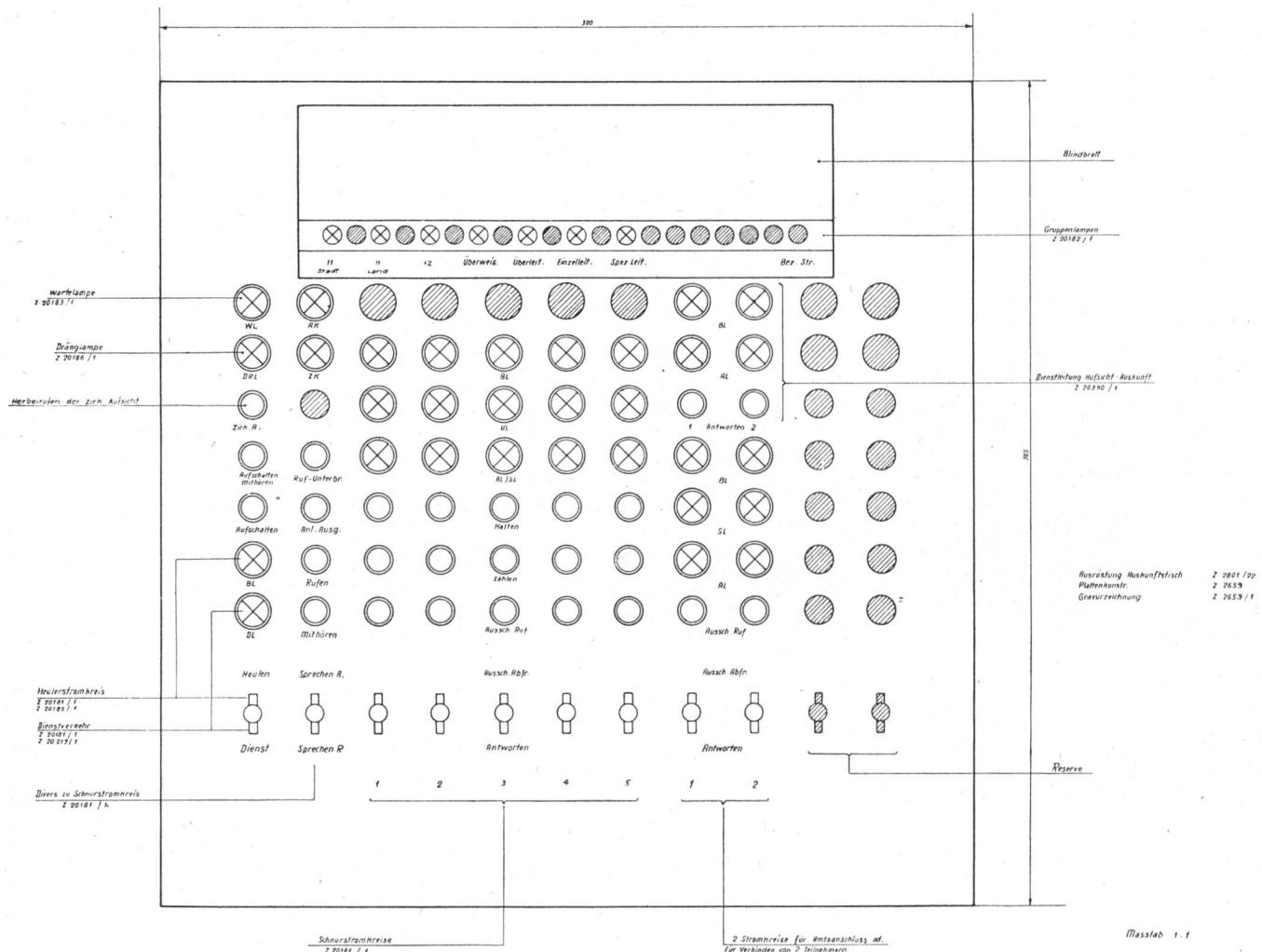
Fig. 7. Verbindungsplatte eines Auskunftsplatzes in Bern.
