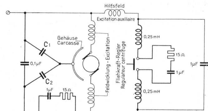
C<sub>1</sub> & C<sub>2</sub> bei geerdetem Gehäuse je 30000 pF
