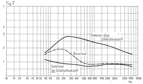
Fig. 7. Nachhallzeiten, Installationsbureau Zürich. — Temps de réverbération dans le bureau des installations, Zurich.
