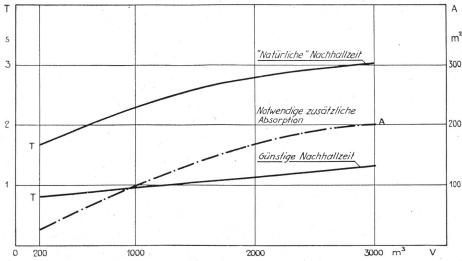
Fig. 1. Mittlere Nachhallzeiten von Bureauräumen moderner Bauweisen. Temps de réverbération moyens dans les bureaux modernes.
