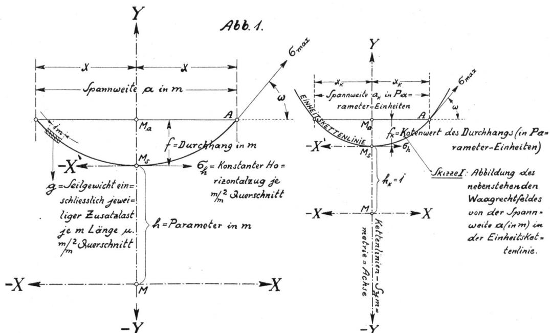
Die Werte  $c_K \cdot \cos \omega$  werden von der Kettenliniensymmetrieachse ( $Y = \text{Achse}$ , Skizze I in Abb. 1) aus als Waagrechtstrecken aufgetragen, und zwar in ganz analoger Weise, wie es hinsichtlich der Werte
