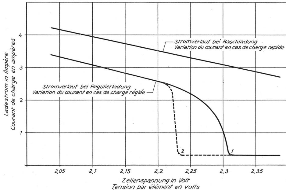
Fig. 5. Ladestrom in Funktion der Zellenspannung. — Courant de charge en fonction de la tension par élément.
