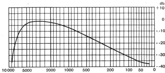
Fig. 3. Frequenzgang der Wiedergabespannung bei konstantem Strom im Aufnahmekopf.
