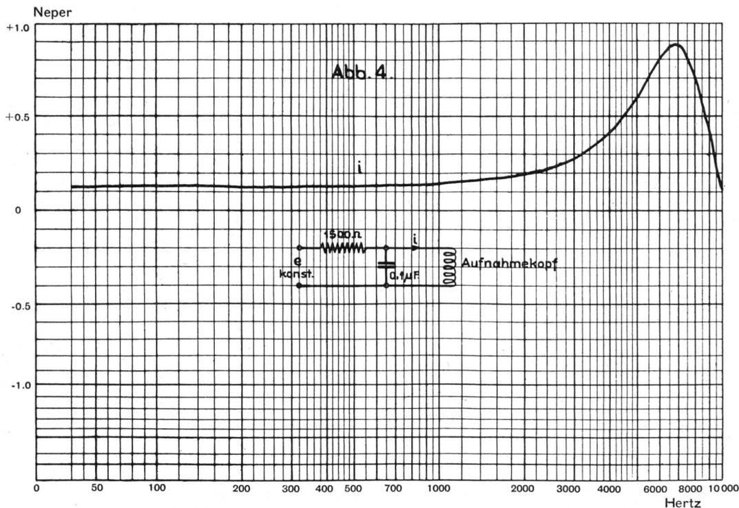
Fig. 4. Strom im Aufnahmekopf in Abhängigkeit der Frequenz bei konstanter Eingangsspannung.
