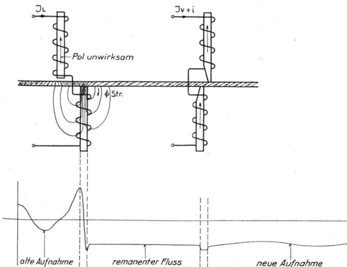
Fig. 8. Vorgang bei falschem Löschen. — Erreur d'effacement.
