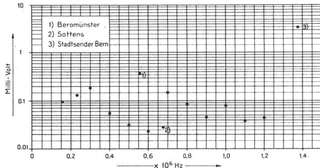
Figur 10: Symmetrische Störspannungen auf einer Teilnehmer-Kabelleitung.
