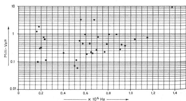
Figur 11: Symmetrische Störspannungen auf einer Freileitung (Nachtempfang der Rundspruchsender).
