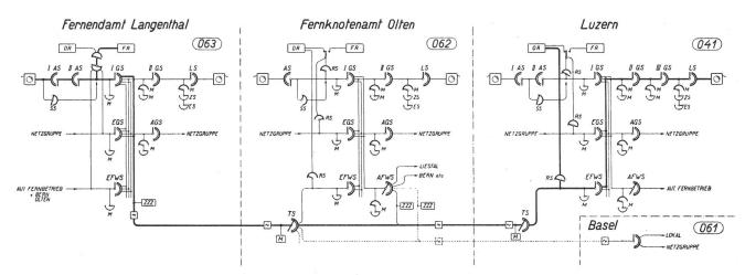
Abb. 9. Verbindungsdiagram m der Tandemverbindung Langenthal-Luzern.
