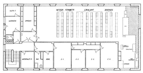
Abb. 2. Situationsplan der automatischen Zentrale Langenthal.
