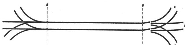
Fig. 8. Prinzip der Richtungswahl mittelst Weichen.
