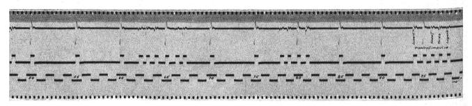
Abb. 8. Oszillogramm, aufgenommen in der Sendestation Zürich. Die Impulse auf den Schritten 5, 10, 15 usw. sind Synchronisierungsimpulse.
