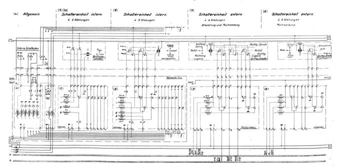
Abb. 3. Schaltung der Schaltereinheiten des Senders, sowie der internen Steuerung der Rundfunkverstärker in Zürich.
