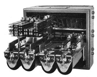
Abb. 6. Stützrelaissatz in einer Empfangsstation, der die Schaltung der Musikleitung vornimmt.
