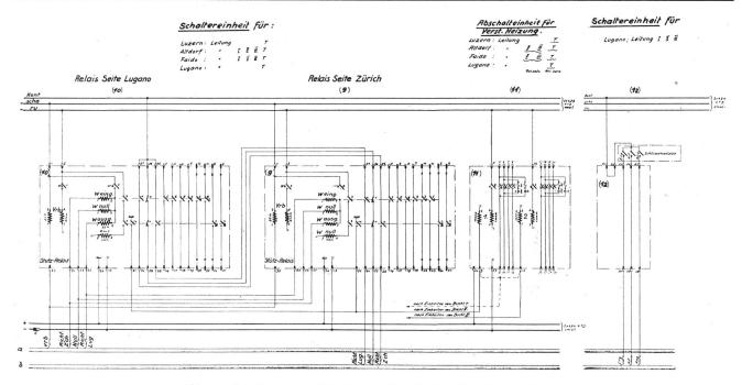
Abb. 4. Schaltung der Schaltereinheiten in den Empfangsstationen.
