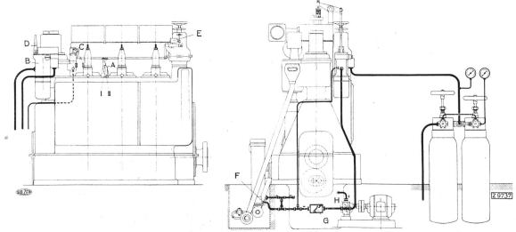
Fig. 16. Schema des Sulzer-Viertakt-Dieselmotors mit automatischer Inbetriebsetzung. Schéma du moteur Diesel à quatre temps à démarrage automatique.
