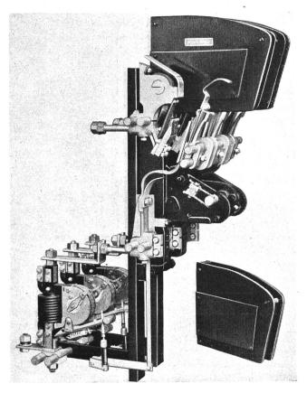
Maximalstromschalter mit unabhängigen Zeitstrom-Fig. 13. Disjoncteur avec relais à temps à déclenchement direct indépendant de l'intensité.
