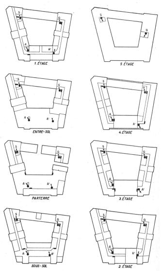
Fig. 19. Steigleitungspunkte. Emplacement des colonnes montantes.
