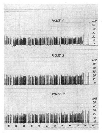
Fig. 12. Belastungskontrolle der Steigleitung: Aufzüge. Contrôle de la charge de la colonne montante des ascenseurs.
