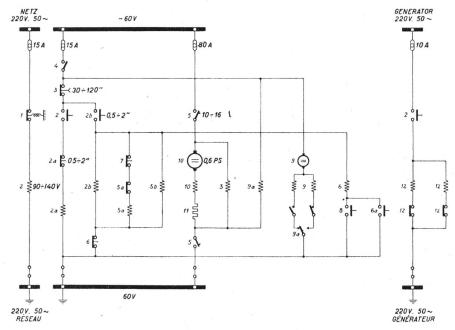
Fig. 17. Schaltfolgeschema. — Suite des opérations de démarrage.
