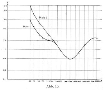
Absorption des schwingungsfähigen Wachstuches bei den tiefen Frequenzen ist auch hier deutlich erkennbar.
