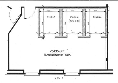
schalig mit 5 cm Luftraum ausgeführt. Die eine Schale besteht aus den erwähnten Schlackensteinen, die andere aus 5 cm starken "Perfecta"-Platten (Gewicht 25 kg/m²). Im Luftraum wurde zur Dämpfung der Querschwingungen eine Matte aus Kokosfaser lose aufgehängt.
