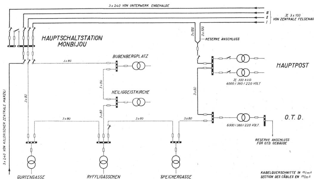
Fig. 5. Ausschnitt aus dem 6-kV-Netz des Elektrizitätswerkes der Stadt Bern.
