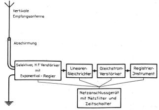
Fig. 2. Anlage für registrierende Schwundmessungen.
