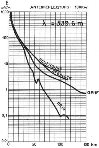
Fig. 12. Dämpfungskurven der Bodenwelle.
