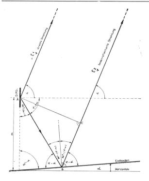
Direkte Strahlung in großer Entfernung:  $E_{\frac{1}{4}} = 60 \, \pi \, \frac{h_{eff}}{\lambda} \, \frac{\Im}{D} \, \cos \theta$ Bodenreflektierte Strahlung in großer Entfernung:  $E_{\frac{2}{4}} = 60 \, \pi \, \frac{h_{eff}}{\lambda} \, \frac{\Im}{D} \, \cos (\theta - 2\alpha)$ Gangunterschied im Bogenmaß  $\frac{1}{4} = \frac{4\pi m}{\lambda} \, \sin (\theta - \alpha) \cos \alpha$
