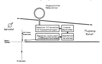
Fig. 3. Flugzeugausrüstung zur Aufnahme vertikaler Strahlungsdiagramme.
