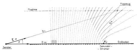
Fig. 10. Interferenzbildung durch punktförmigen Sekundärstrahler am Erdboden. Hyperbelschar:  $D_1$ — $D_2$  = n. $\lambda$  n = ganzzahliger Parameter.
