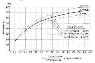
Bei Fernwahl über mehrere Durchwahlsätze wird sich ein ursprünglich ideales Verhältnis oft verändern, ohne dass eine Störung zu sein braucht. Z. B. beeinflusst das Einsetzen des Wechselstromes im Null- oder im Scheitelpunkt der Sinuskurve die Arbeitsweise des Relais. Ferner addieren sich die verschiedenen kleinen erlaubten Verzerrungen der einzelnen Durchwahlsätze usw.
