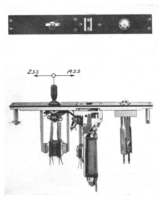
$\begin{array}{ccc} & \text{Fig. 4b.} & \text{Taxanzeiger.} \\ \text{ZSS} & \text{Z\"{a}hlung einleiten.} & \text{RSS} & \text{Taxanzeiger zur\"{u}ckstellen.} \end{array}$
