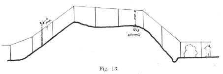
profondeur à laquelle les poteaux doivent être enfouis augmentant avec leur hauteur au-dessus du sol, on utilisera de préférence une échelle du genre représentée ci-après, établie sur du papier calque d'après l'échelle adoptée pour le profil et où les diverses longueurs de poteaux sont dessinées en couleurs différentes.
