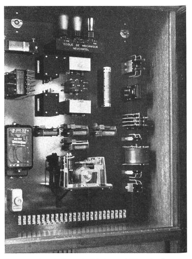
Fig. 6. Zeitzeicheneinrichtung für Telephon- und Telegraphendienst. Emetteur des signaux horaires téléphoniques et télégraphiques.
