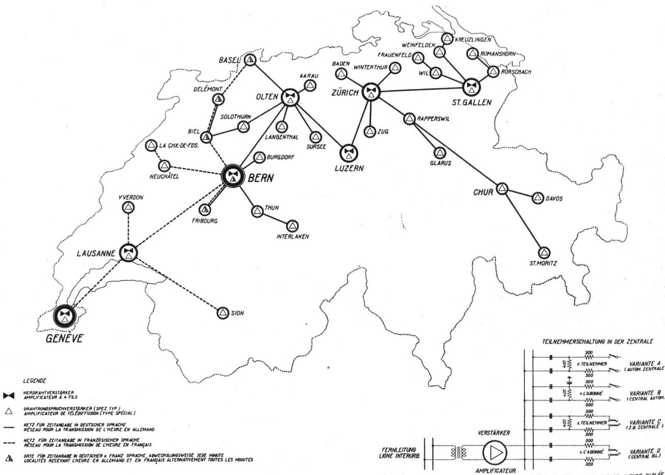
Fig. 9. Verteilungsnetz für die Zeitansage. — Réseau de distribution de l'heure parlée.
