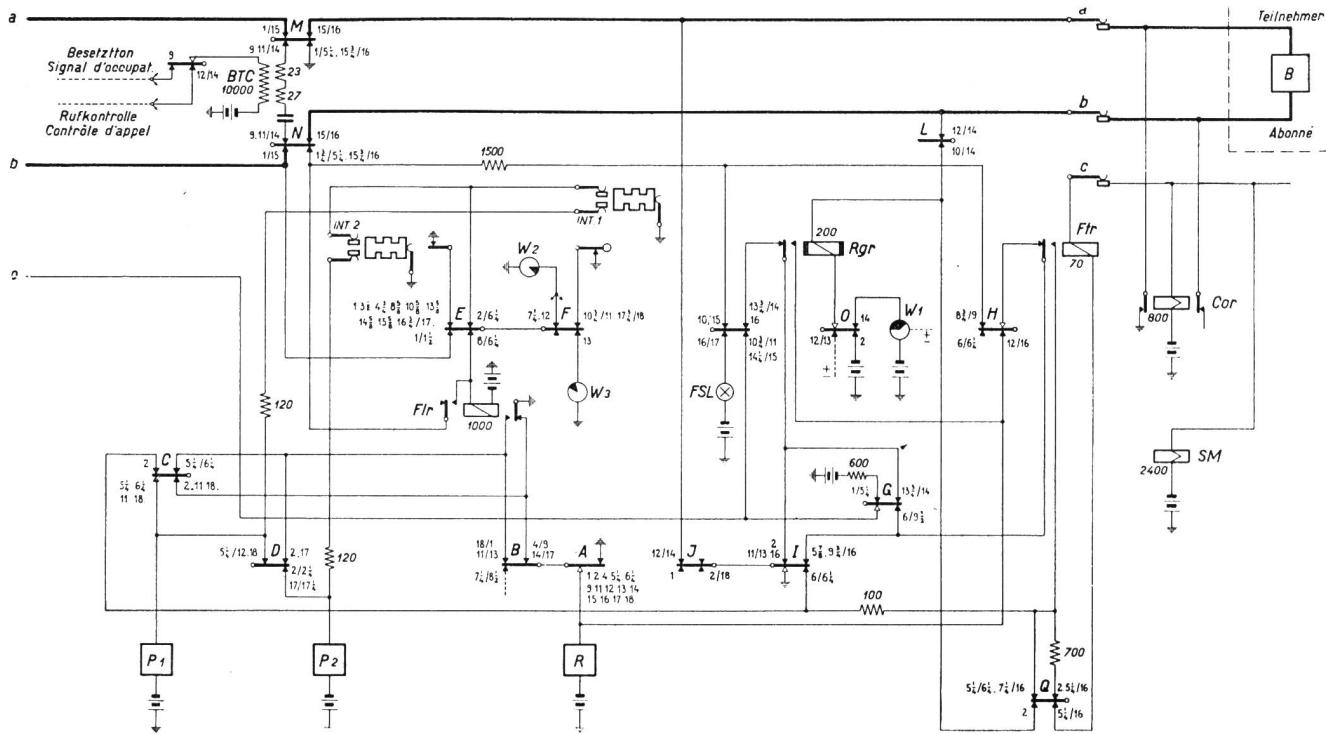
Fig. 21. Leitungswählerstromkreis. --- Circuit du sélecteur de ligne.
