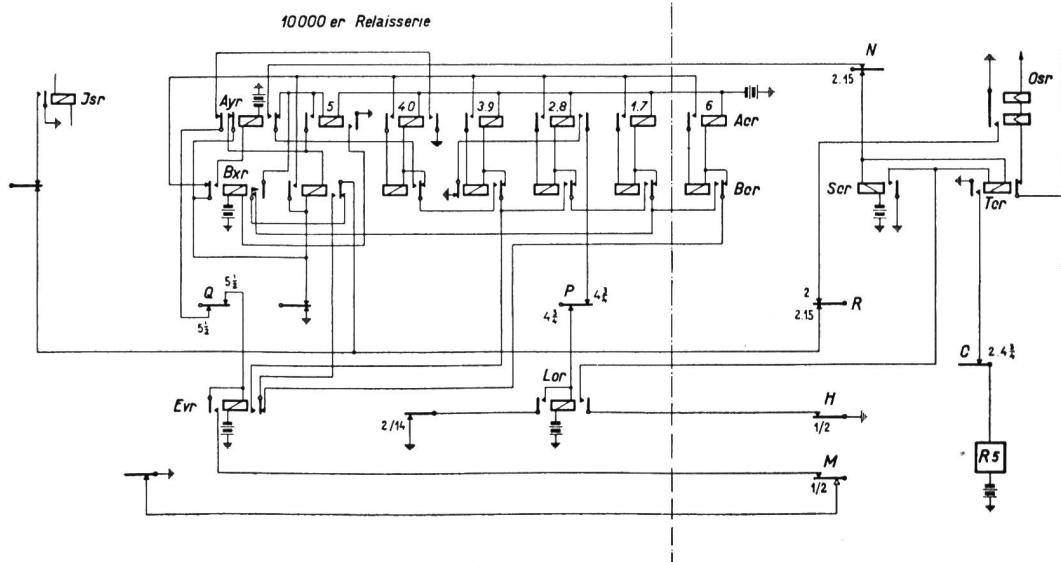
Fig. 15. Korrektur des Wählvorganges. — Correction de la sélection.
