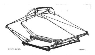
Ansicht eines der 183 für die Basler Strassenbahnen und die Birseck-Bahn Basel gelieferten Scherenstromabnehmer mit Kohlenschleifstücken.
