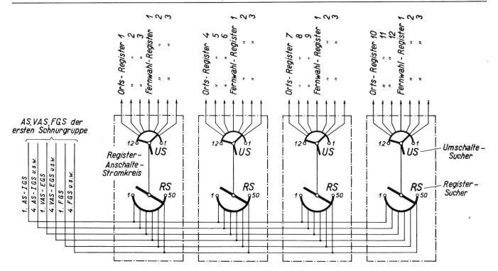
Abb. 5. Darstellung einer der drei Schnurgruppen in Verbindung mit den Register-Anschaltestromkreisen.
