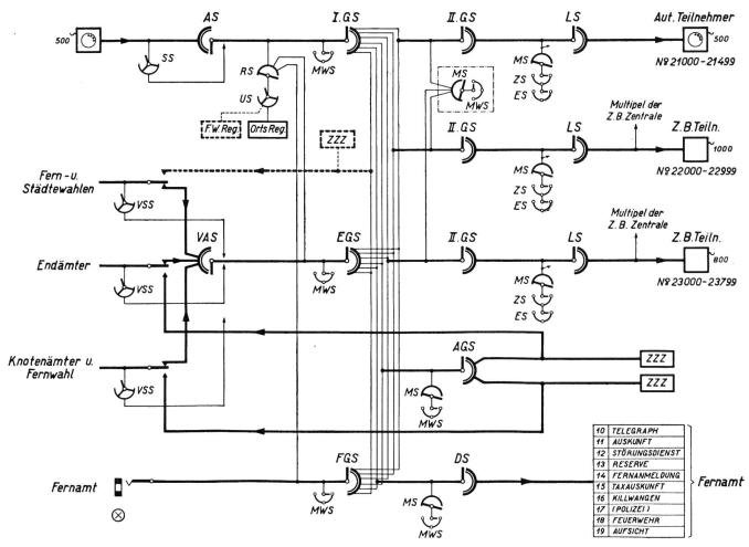
Abb. 3. Verbindungsdiagramm des automatisierten Teiles der Zentrale Baden. Legende.
