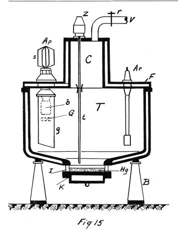
Die Anoden werden durch Ableitung gekühlt, und die Hauptanoden sind ausserdem mit Kühlrippen s versehen. Ein Blechgehäuse g schützt die Graphitanoden b und die 15 mm darunter befindlichen Gitter G.
