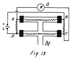
Das Hitzdrahtinstrument bietet den grossen Vorteil der direkten und dauernden Ablesung auf Entfernung, da der Anzeigeapparat (Galvanometer) am Kommandopult angebracht ist.
