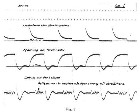
Die Scheitelspannung des auf die beschriebene Weise erzeugten Impulses steht in sehr einfacher Beziehung zur Spannung der verwendeten Batterie. Für ein Verstärkerfeld genügt eine Spitzenspannung von 80 Volt kabelseitig, was in der Schaltung 1 eine Batteriespannung von 50 Volt benötigt, entsprechend dem Uebersetzungsverhältnis des verwendeten Linienübertragers.
