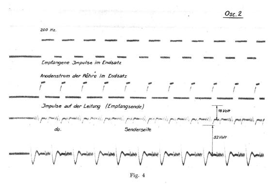
tragung von Nummernwahlimpulsen im Fernsprechverkehr darf die Zeitdauer des Zyklus höchstens 80 Millisec. betragen. Oszillogramm 2 illustriert den Vorgang. Zwischen Senderseite und Empfangsende lagen bei der oszillographischen Aufnahme drei Uebertragungen nach Fig. 3 mit betriebsmässig eingeschalteten Zweidrahtverstärkern (Fig. 5). Die kleinen Zacken im Oszillogramm zwischen den eigentlichen Impulsen rühren von Reflexionen und direkter Uebertragung durch die Verstärker her.
