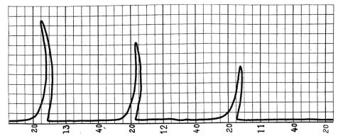
Fig. 3. Geräuschdiagramm für Lichtstrombelastung bei positiver Fahrleitung; die darin sichtbaren Störungszacken entsprechen Totalunterbrechungen an den Aufhängepunkten der Fahrleitung ( $\sqrt{Papier}$ : 10 mm/sec).
