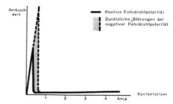
Fig. 5. Grundsätzliche Störkennlinien bei Voraussetzung bestimmter Distanzierungen, Kathodeneigenschaften und Fahrgeschwindigkeit, für positive und negative Fahrdrahtpolaritäten.
