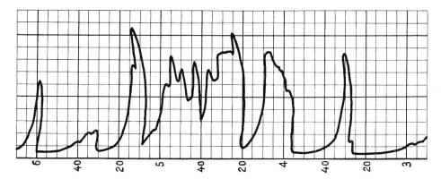
Fig. 4. Geräuschdiagramm für Lichtstrombelastung abei negativer Fahrleitung; die Störungszacken der Aufhängepunkte blieben gegenüber Fig. 3 als Totalunterbrechungen amplitudenmässig erhalten — dazwischen traten jedoch Störungsgruppen infolge von Totalunterbrechungen an der Fahrdrahtriffelung.
