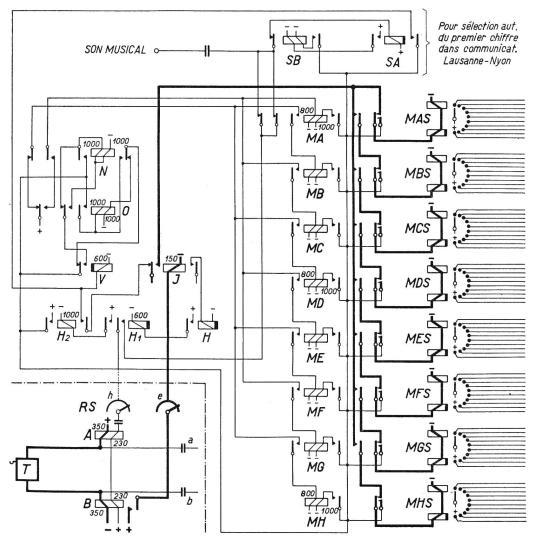
Fig. 5. Enregistrement des impulsions.
