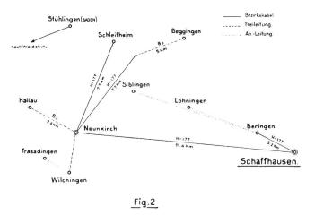
Die Automatisierung der Netzgruppe Neunkirch im Jahre 1933 hat, wie überall, eine umwälzende Vereinfachung des Leitungsnetzes zur Folge gehabt. Fig. 1 zeigt das Netz vor, Fig. 2 nach der Automatisierung. Eine Begründung der Vereinfachung ist im
