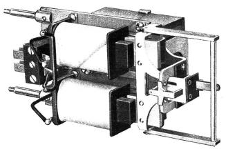
Fig. 9. Le relais à courant alternatif.
