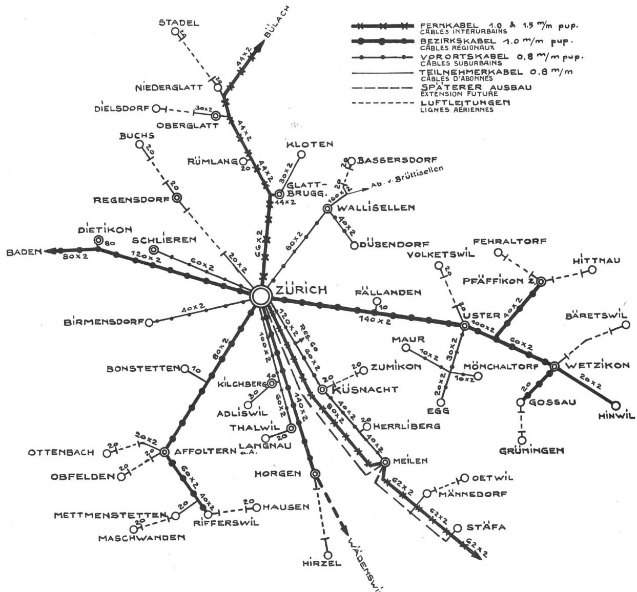
Fig. 10. Kabelnetzplan. — Plan du réseau des câbles.
