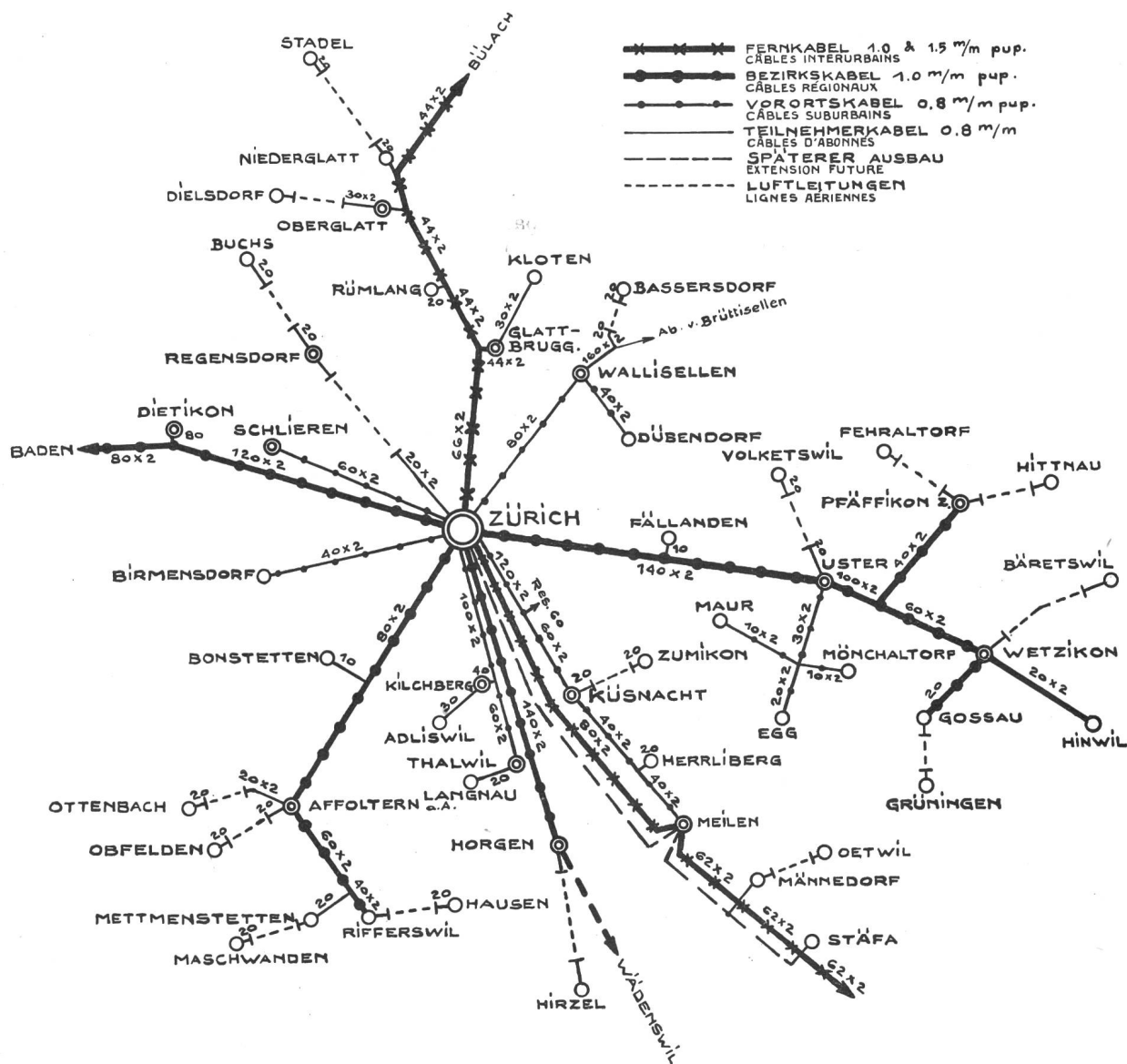
Fig. 10. Kabelnetzplan. — Plan du réseau des câbles.
