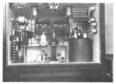
Fig. 3. Trennverstärker. — Separatore.
