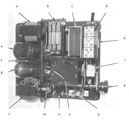
Fig. 5. Telephon-Endverstärker Amplificateur téléphonique
