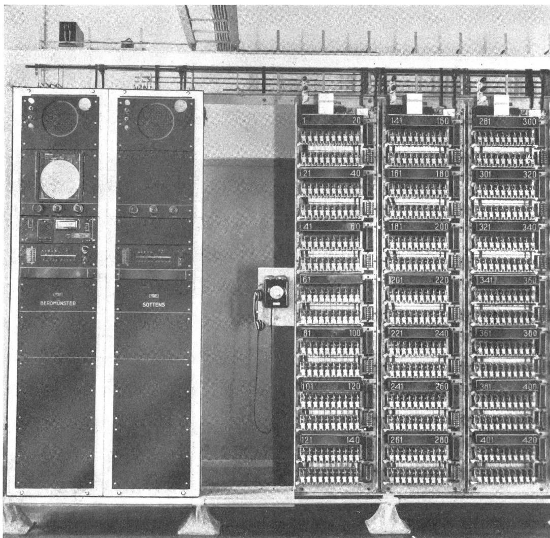
Fig. 5. Programmwähler- und Verstärkergestelle. — Bâts des sélecteurs de programmes et des amplificateurs.
