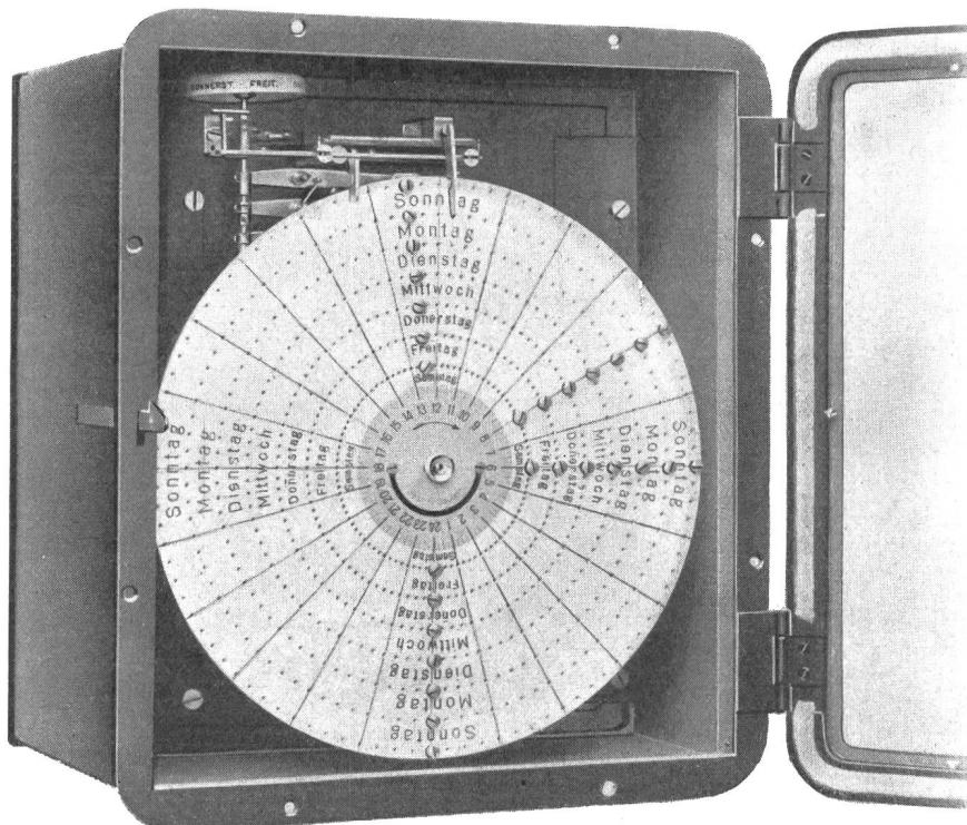
Fig. 6. Schaltuhr. — Minuterie.
