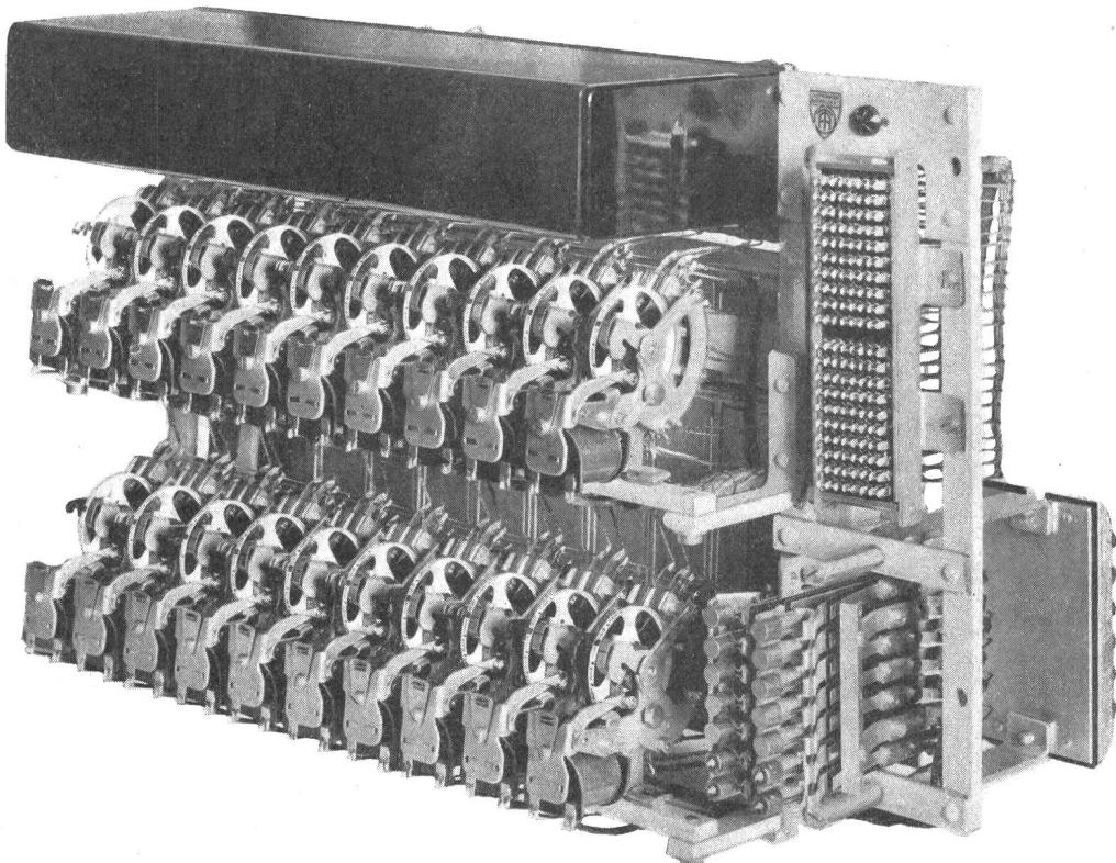
Fig. 4. Programmählerrahmen. — Cadre des sélecteurs de programmes.
