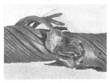
Bild 6. Vom Starkstrom zerstörtes Bezirkskabel Filisur—Bergün.
