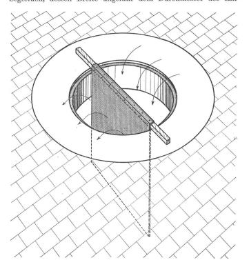
steigloches des Schachtes entspricht und das eine Länge von 80 bis 100 cm hat, wird so in das Einsteigloch gehängt, dass dieses von dem Tuch in zwei möglichst gleiche Teile geteilt wird. Dadurch bewirken wir, dass das Loch nun auch für die Luftströmung geteilt wird, was sich sofort deutlich bemerkbar macht: Auf der einen Seite des Tuches entweicht die warme und schlechte Luft aus dem Schacht, während auf der andern Seite ungehindert frische Luft zufliesst.
