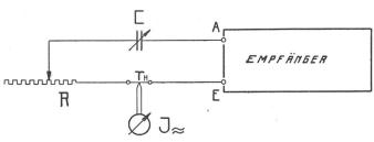
Bild 1: Bestimmung der Sendeleistung.
