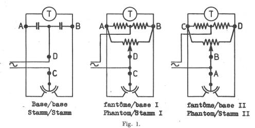
Kopfhörer Null, bzw. ein Minimum erreicht hat. Ein Walzenschalter ermöglicht, die Umschaltung gemäss den drei Schemas in rascher Folge vorzunehmen und gestattet ferner auch die Messung der Erdunsymmetrien, deren Ausgleich analog demjenigen von Stamm/Stamm oder Phantom/Stamm vorgenommen wird.
