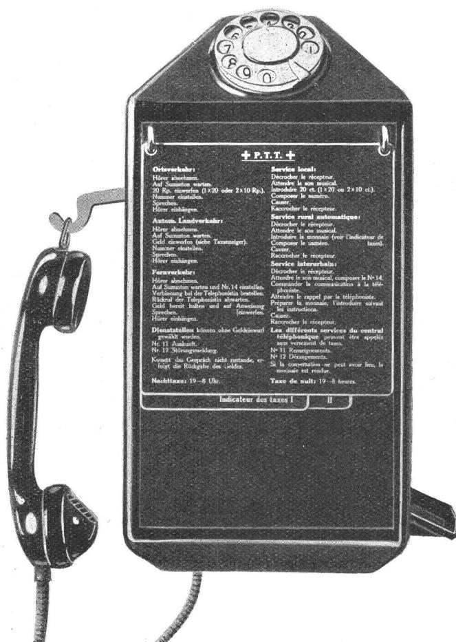
Fig. 16. Kassierstation komplett, mit Bedienungstafel und Tax'anzeigekarten.
