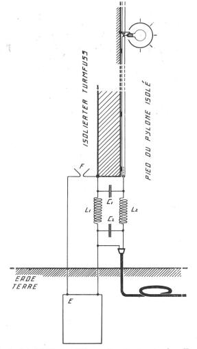
Abb. 1. Schaltbild des Filters: F=Funkenstrecke, E=Erdplatte,  $L_1=L_2=3$  mH,  $C_1=C_2=2$  MF (4000 V.), Hochfrequenzableitung der Filteranlage = 0,13 Amp.
