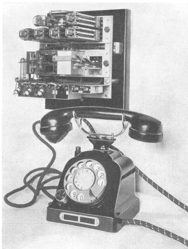
Fig. 11. Station mit Beikasten für wahlweisen Anruf. Station avec boîte accessoire pour l'appel sélectif.
