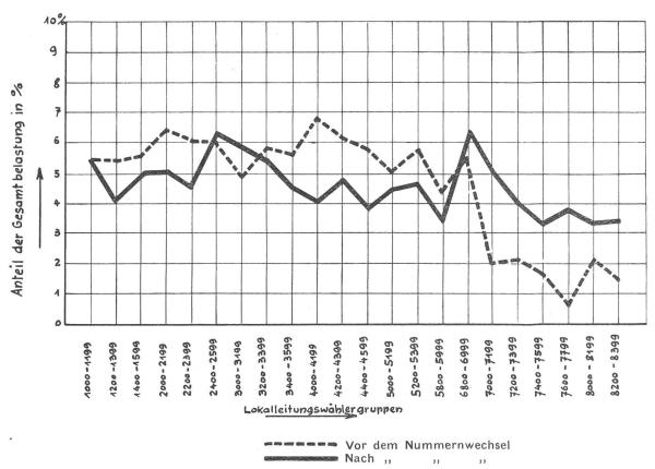
Fig. 11. Vergleich der Belastung von 22 Lokalleitungswählergruppen.
