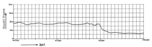
Fig. 8. Kurve der Gesamtbelastung des Automatenamtes Safran I.
