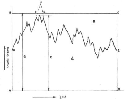
Fig. 5. Bezeichnung der verschiedenen Grössen einer Verkehrskurve.
