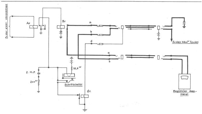
Fig. 9. Vorrichtung zur gleichzeitigen Beobachtung mehrerer Gruppen.
