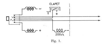
Pour les boîtes de commutation 1/1 d'embranchement. Il est très facile d'alimenter le clapet d'appel par un pôle positif et le fil devenu libre par le pôle négatif d'une batterie supplémentaire à travers une résistance 200 ohms; échanger le jack à 5 lames par un jack à 7 lames et alimenter celui-ci par un graduateur  $2\times 200$  ohms suivant schéma n° 1. Grâce à ce petit changement à la centrale B. L., il est possible de terminer l'installation chez l'abonné.
