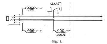
Pour les boîtes de commutation 1/1 d'embranchement. Il est très facile d'alimenter le clapet d'appel par un pôle positif et le fil devenu libre par le pôle négatif d'une batterie supplémentaire à travers une résistance 200 ohms; échanger le jack à 5 lames par un jack à 7 lames et alimenter celui-ci par un graduateur  $2\times 200$  ohms suivant schéma n° 1. Grâce à ce petit changement à la centrale B. L., il est possible de terminer l'installation chez l'abonné.
